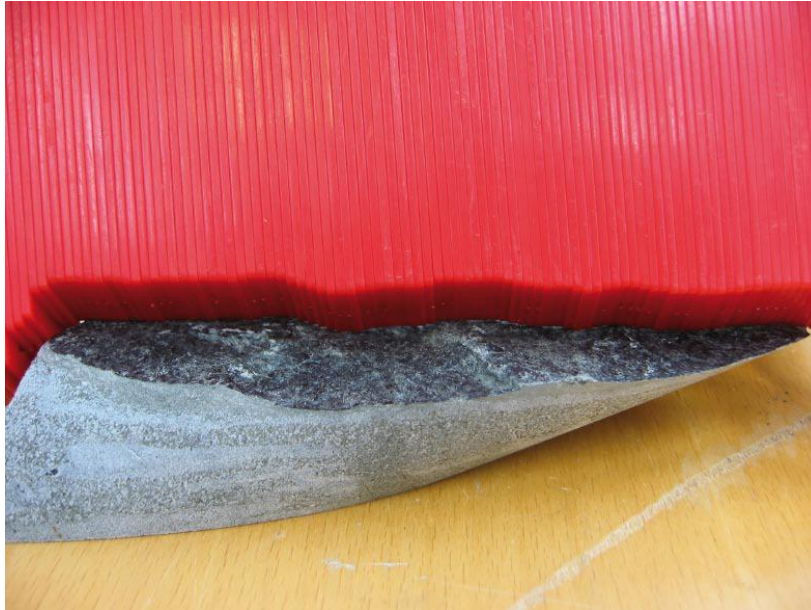
4-10. ábra. JRC mérése tagolófelületen Barton fésű alkalmazásával
