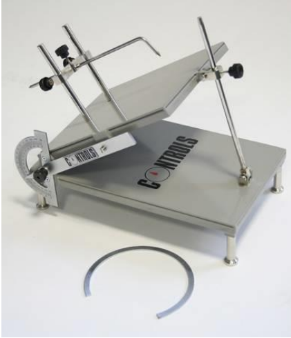
4-16. ábra. Döntéses (csúszásos) vizsgálat műszere valamint mérés fűrőmagokon
