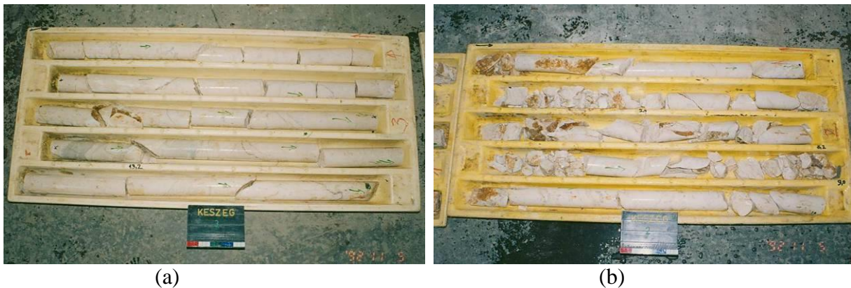
3-20. ábra. Egy ép (a) és egy nagyon töredezett (b) kőzettest magládája
