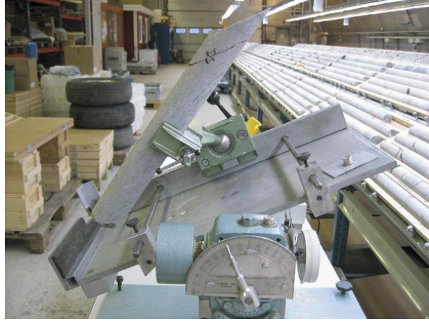
4-16. ábra. Döntéses (csúszásos) vizsgálat műszere valamint mérés fűrőmagokon
