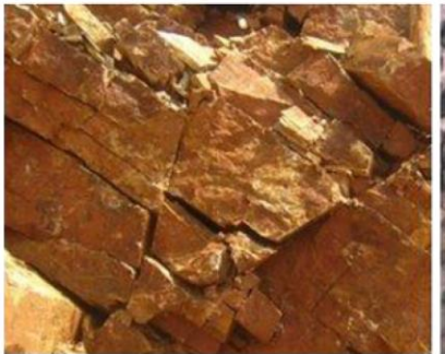
3-5. ábra: Tagoltságok megjelenési formái a kőzettestben:
