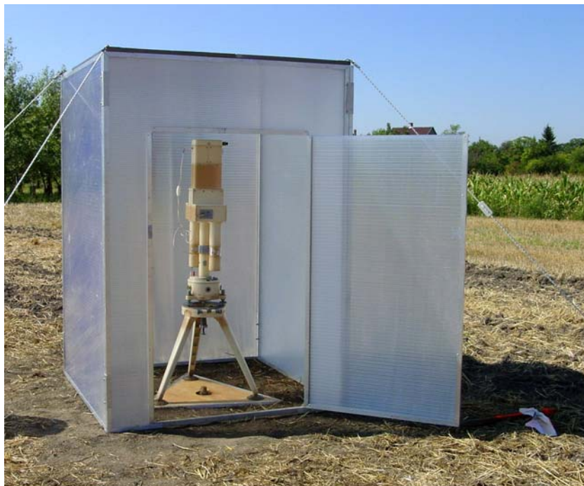
14. ábra. E54 inga az ELGI-BME makádi mérésein 2007-ben.
