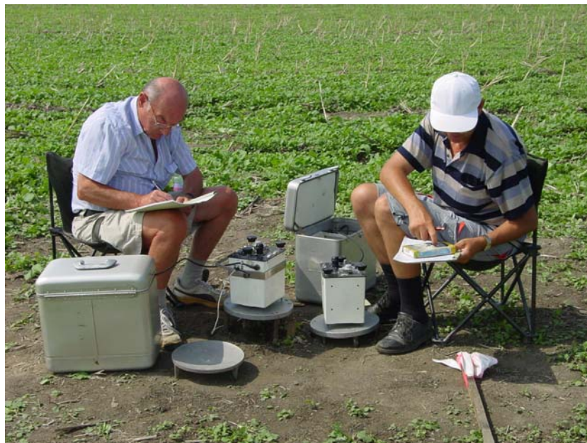
8. ábra. Graviméteres mérések az ELGI-BME makádi mérésein 2007-ben LCR graviméterekkel.
