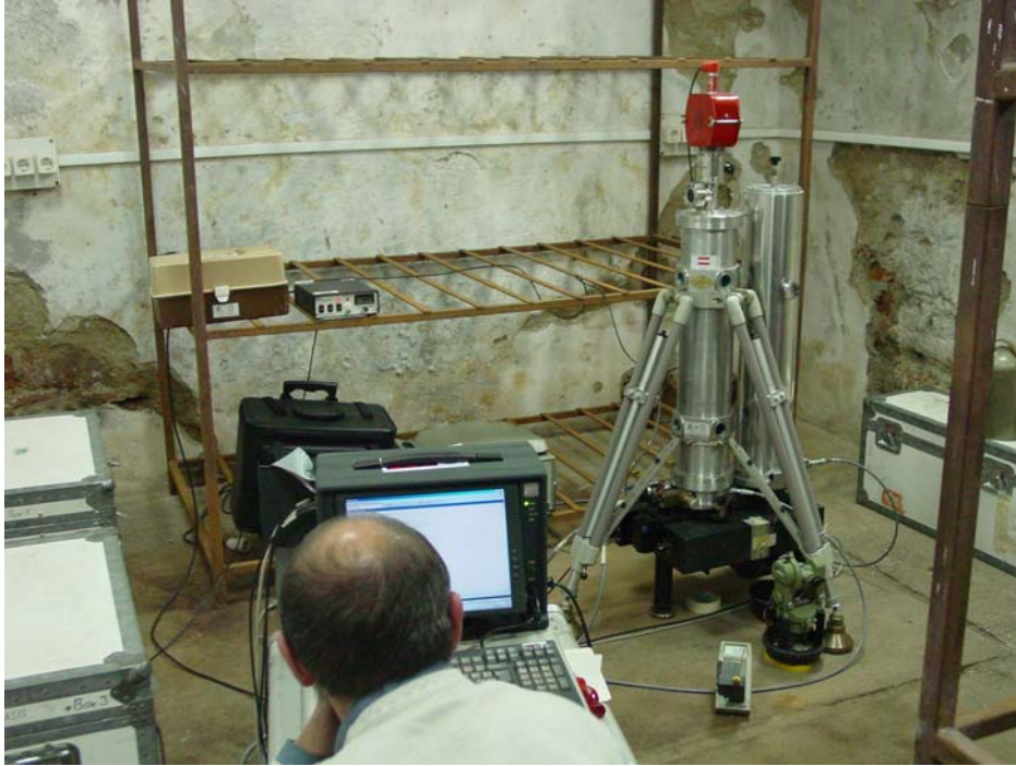
1. ábra. JILAg-6 abszolút graviméter a kenderesi mérésen 2005-ben
