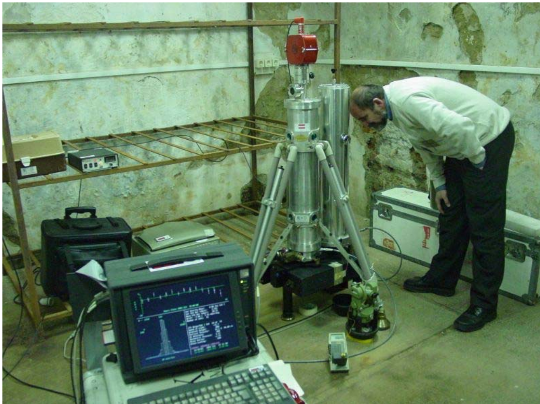
2. ábra. Mérés a Jilag-6 abszolút lézergraviméterrel Kenderesen 2003-ban
