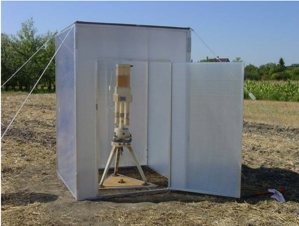
1. ábra. E-54 inga az észlelőházban mérésre kész állapotban a teherelosztó háromszögön.
