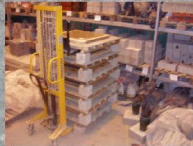
Próbatetek tárolása (utókezelés - locsolással)
