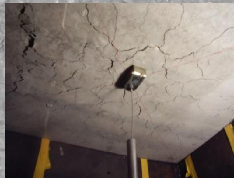
Vasalt lemezek tönkremenetele
