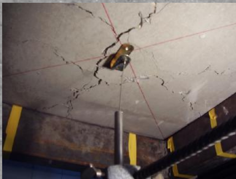
Vasalás nélküli lemez tönkremenetele
