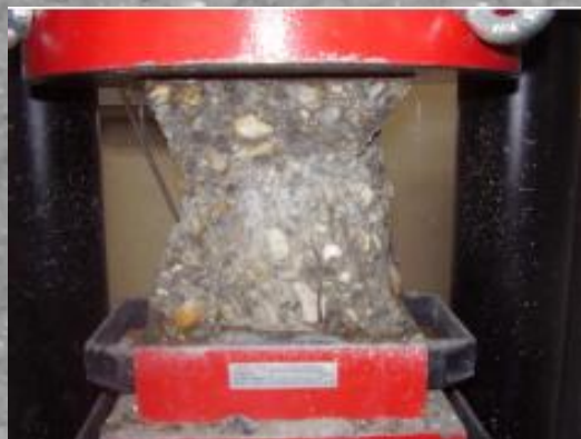
Szál nélküli próbatest törésképe - rideg jellegű tönkremenetel -
