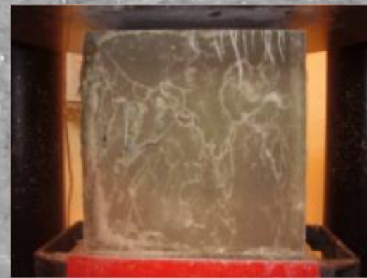
Száladagolású próbatest törésképe - képlékeny jellegű tönkremenetel -
