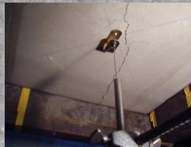
Útadó elhelyezése a próbatesten
