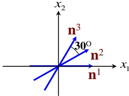
$$\mathbf{n}^1 = \begin{bmatrix} +1 \\ 0 \end{bmatrix}; \quad \mathbf{n}^2 = \begin{bmatrix} +0,866 \\ +0,5 \end{bmatrix}; \quad \mathbf{n}^3 = \begin{bmatrix} +0,5 \\ +0,866 \end{bmatrix};$$
