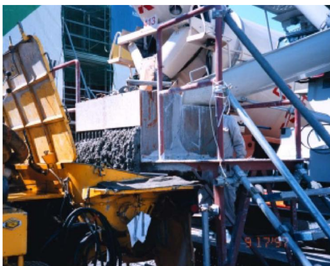
4.1. kép: automatikus berendezés a helyszíni megfelelőségi vizsgálatához
