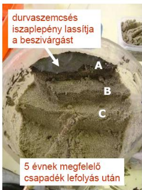
4.14 ábra: Lefolyás szűrése homoktölteten (Budai, 2008)
