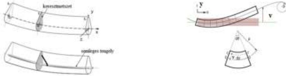
2. Ábra: Hajlított Euler-Bernoulli félegerendák keresztmetszetének és semleges tengelyének a sematikus képe az alakváltozás után.
